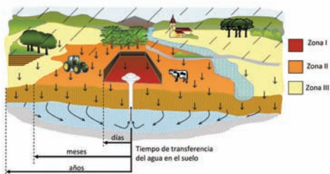
Figura 12. Ejemplo de zonificación en función del tiempo de tránsito. Fuente: "La protección de captaciones". Organización Mundial de la Salud
